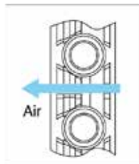
Minimierung des Druckverlustes durch modernisiertes Luftaustrittsgitter
