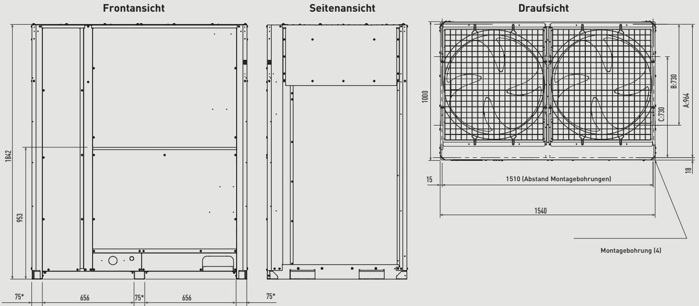
Je nach Einbausituation vor Ort können für die Position der Ankerschrauben die Maße A, B oder C verwendet werden.
