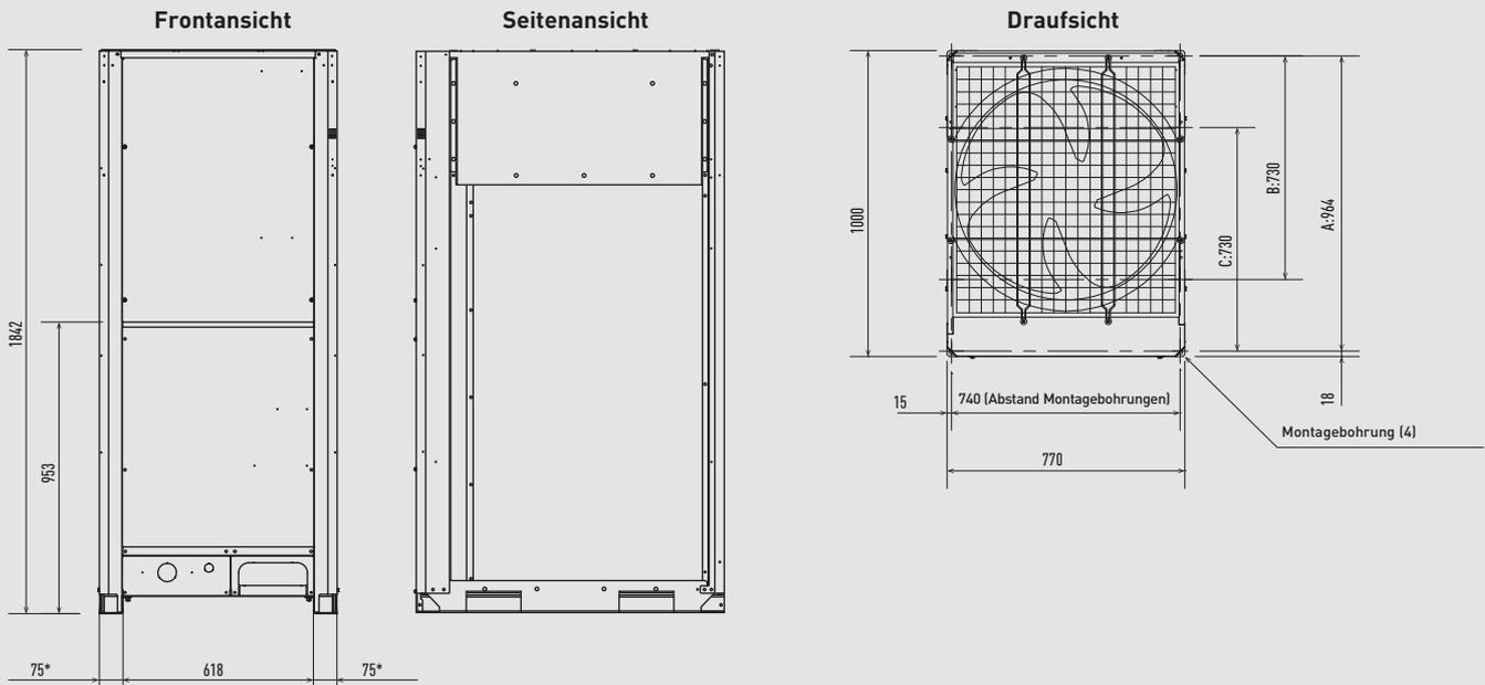
Je nach Einbausituation vor Ort können für die Position der Ankerschrauben die Maße A, B oder C verwendet werden.
