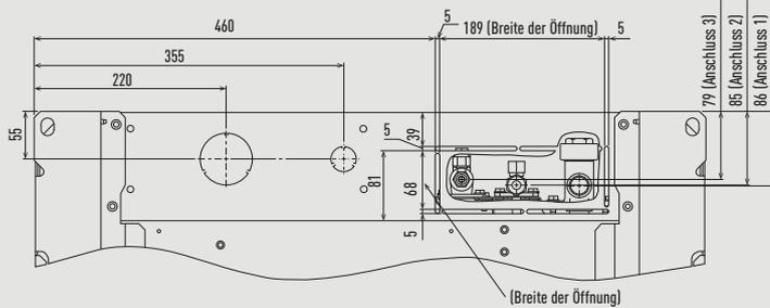
Position der Kälteanschlüsse
