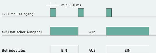
**HINWEIS:** Die Leitungslänge zwischen Innengerät und Relais darf max. 2 m betragen. Der Impulseingang kann durch Durchtrennen der Kontaktbrücke JP001 zum statischen Eingang gemacht werden.
