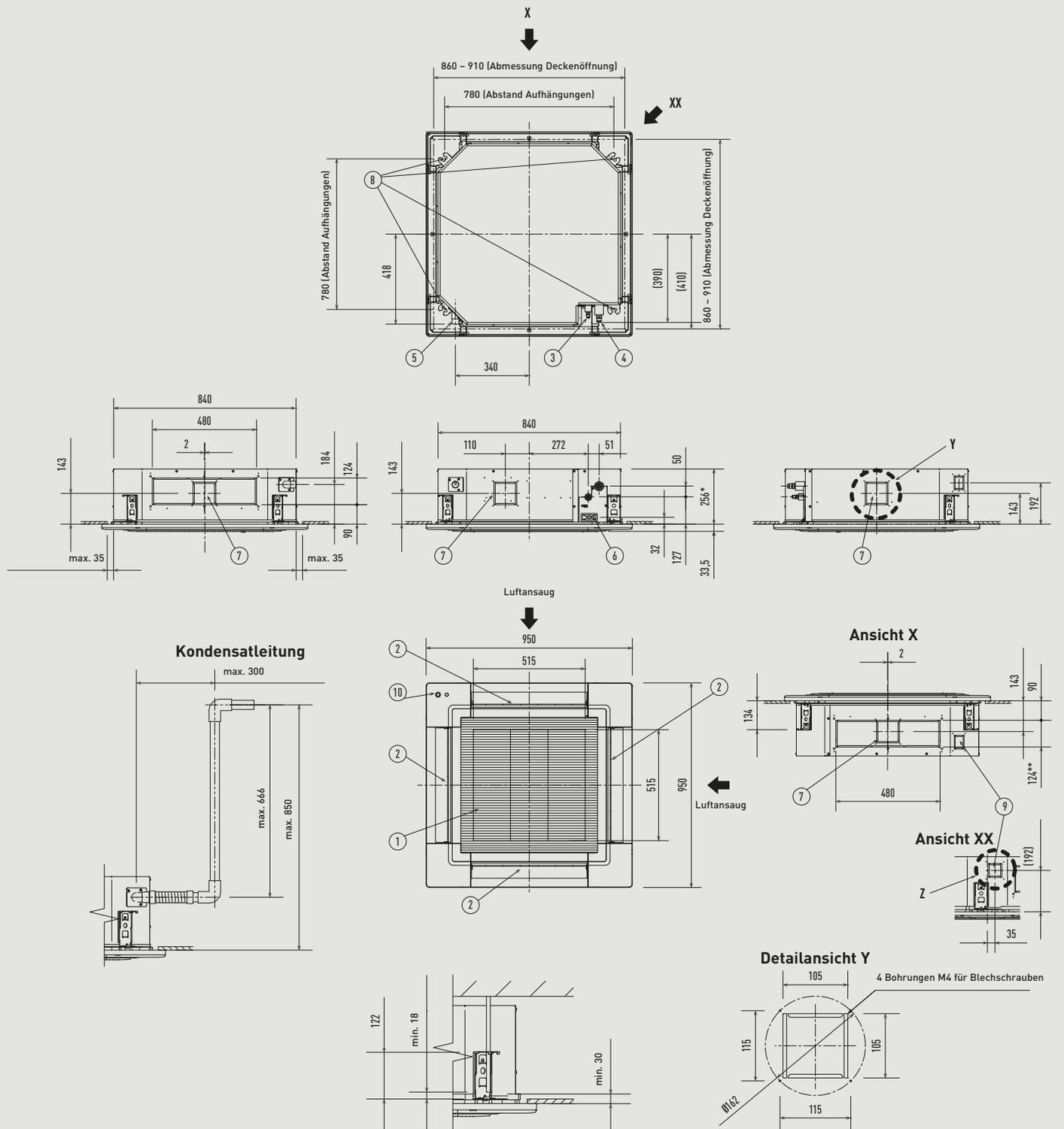
Die Länge der Gewindestangen ist so zu wählen, dass der Abstand zur Deckenunterkante mindestens 30 mm (bzw. der Abstand zur Geräteunterkante mindestens 18 mm) beträgt, wie in der Abbildung dargestellt. Wenn die Gewindestange zu lang ist, berührt sie die Deckenblende, sodass eine Installation des Geräts nicht möglich ist.
