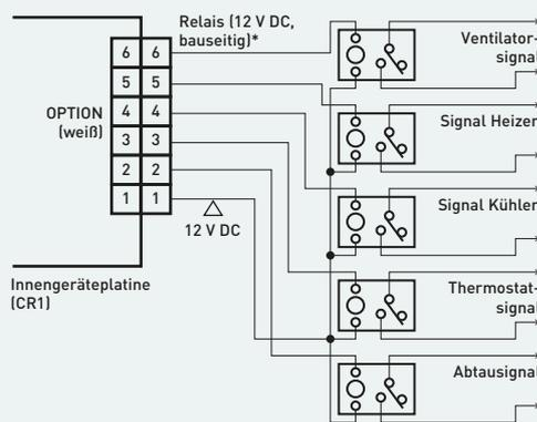
\* Das Relais darf sich maximal 2 m von der Platine entfernt befinden.
