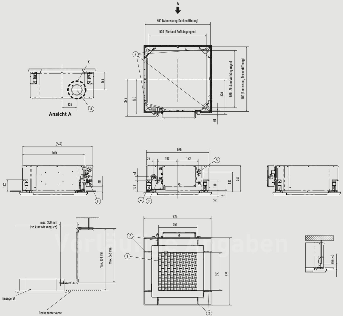
\* Länge des vorhandenen Kondensatschlusses: 250 mm
