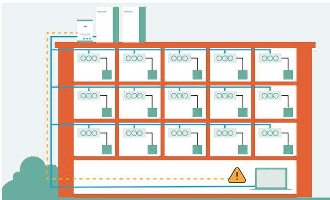
Abb. 2: Herkömmliches, eigenständiges Leckage-Erkennungssystem
